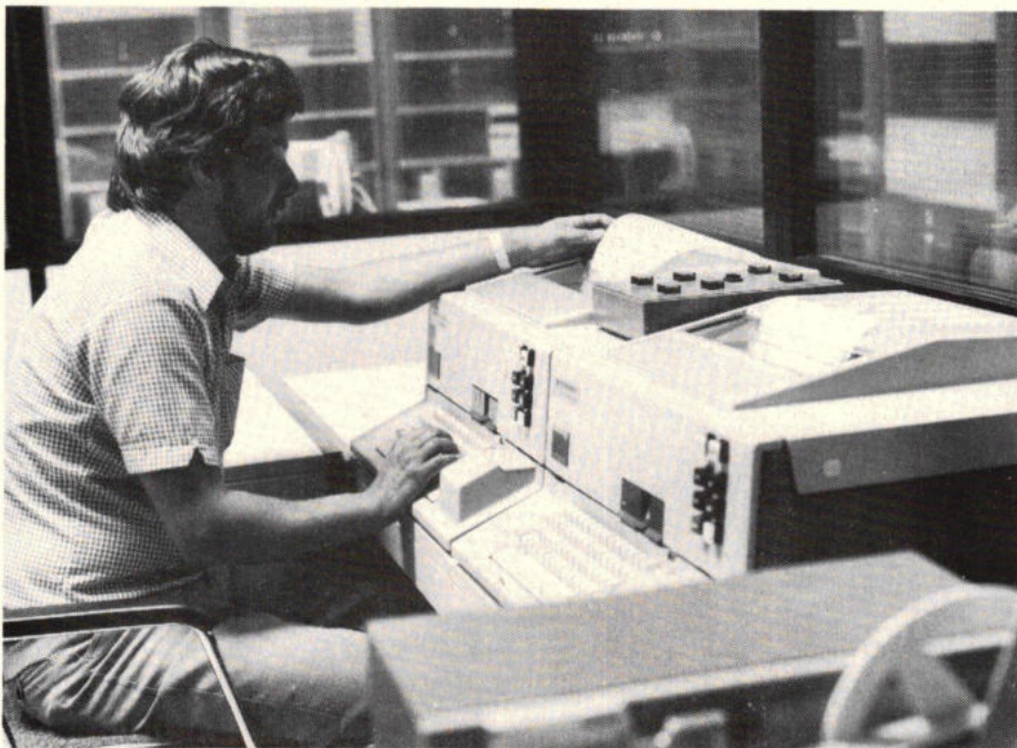
Afb. 1. Bedieningsschrijfmachine van de vier computers tellende automatische telexgeheugencentrale bij de Deutsche Wetterdienst.
